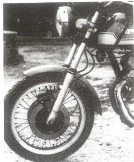
Le freinage est assuré par deux disques Brembo à l'avant, ce qui est amplement suffisant. Notez le bleuissement des pots et les incrustations de rouille dues aux projections.
