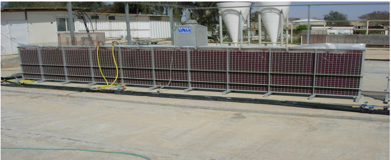
Production algal extérieur en panneau vertical
