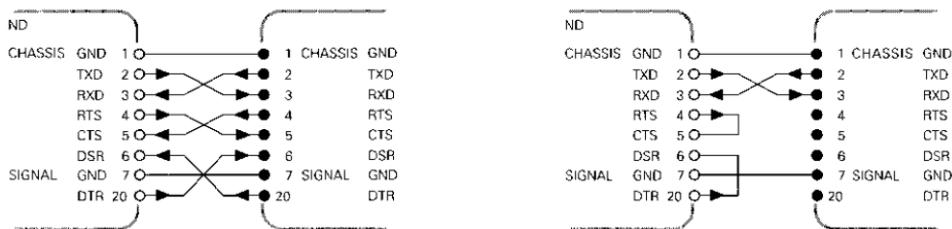
**CHASSIS GND:** masse boîtier, **TXD:** données émission, **RXD:** données réception, **RTS:** demande émission, **CTS:** prêt à émettre, **DSR:** unité transmission prête, **SIGNAL GND:** masse 0V, **DTR:** appareil réception des données prêt.
