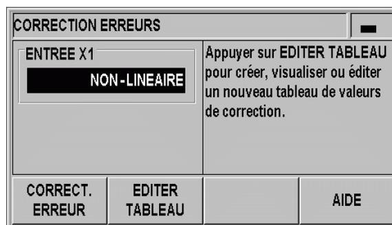
fig. II.22 Masque d'introduction pour la correction d'erreur non-linéaire
