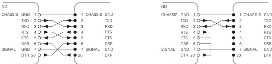
**CHASSIS GND:** masse boîtier, **TXD:** données émission, **RXD:** données réception, **RTS:** demande émission, **CTS:** prêt à émettre, **DSR:** unité transmission prête, **SIGNAL GND:** masse 0V, **DTR:** appareil réception des données prêt.
