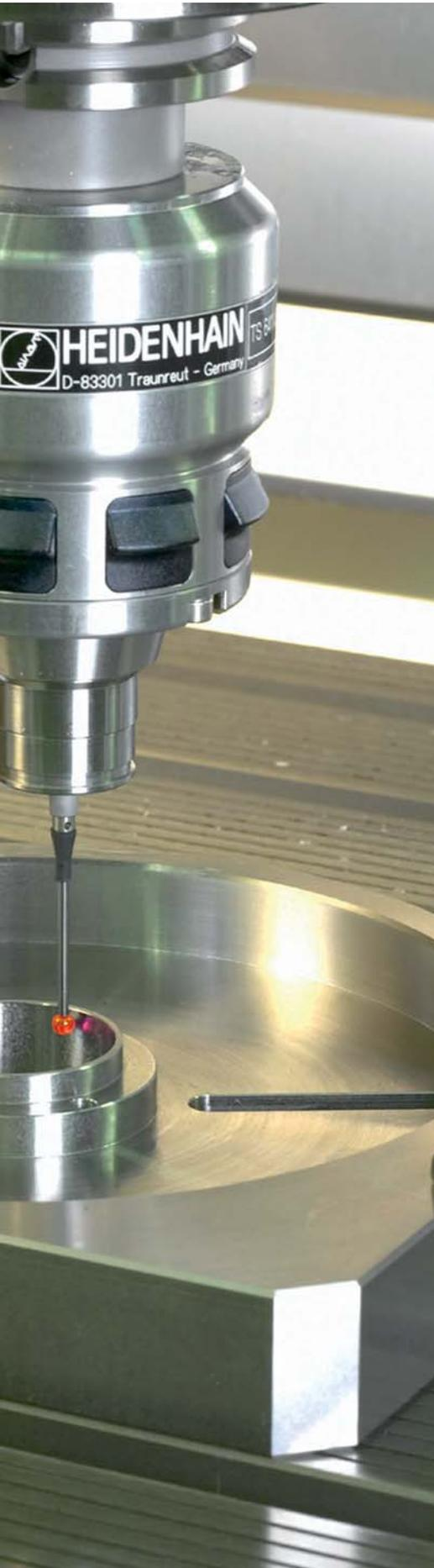
Les programmes d'usinage de la pièce se réfèrent aux points de référence. Un enregistrement rapide et fiable du point d'origine à l'aide d'un palpeur de pièces réduit les temps morts et améliore la précision de l'usinage. Selon les fonctions de palpation dont dispose la CN, les palpeurs TS de HEIDENHAIN permettent d'initialiser automatiquement les points de référence.
