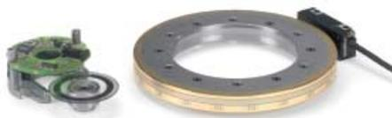
Sur les **systèmes de mesure angulaire et capteurs rotatifs incrémentaux**, la position courante – à partir d'un point de référence – est déterminée en comptant les pas de mesure ou les périodes des signaux après subdivision. Pour reproduire le point de référence, les appareils de mesure incrémentaux HEIDENHAIN possèdent des marques de référence.
