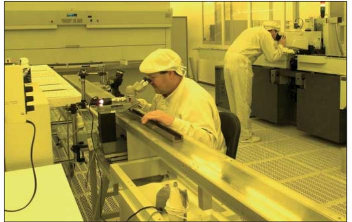
Poste de contrôle pour règles de mesure en lithographie
