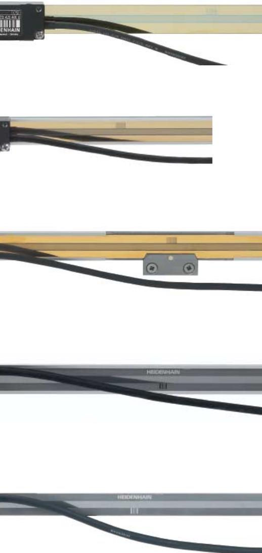
Les systèmes de mesure linéaire à règle nue de la série **LIDA 503** sont conçus pour des emplacements de montage réduits. Ils se composent d'une tête caprice de faibles dimensions et d'une règle de mesure en verre facile à coller directement sur la machine avec le film de montage PRECIMET.
