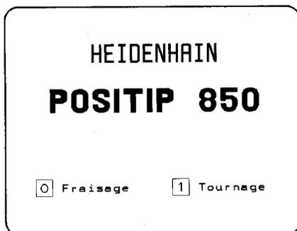
En appuyant sur la touche , le programme "fraisage" est protégé en mémorisation. Toute nouvelle modification permettant de retourner au mode d'utilisation "tournage" ne peut être effectuée qu'au moyen du paramètre P99.0 "Fraisage, Tournage" (cf. paramètres, paragr. 4.2).
