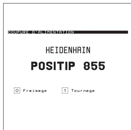
Fig. 34: L'écran du POSITIP après la première mise sous tension
