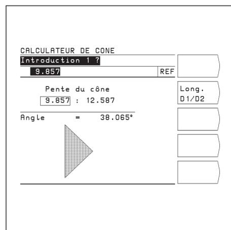
Fig. 26: Calcul de la pente du cône à partir de l'angle du cône
