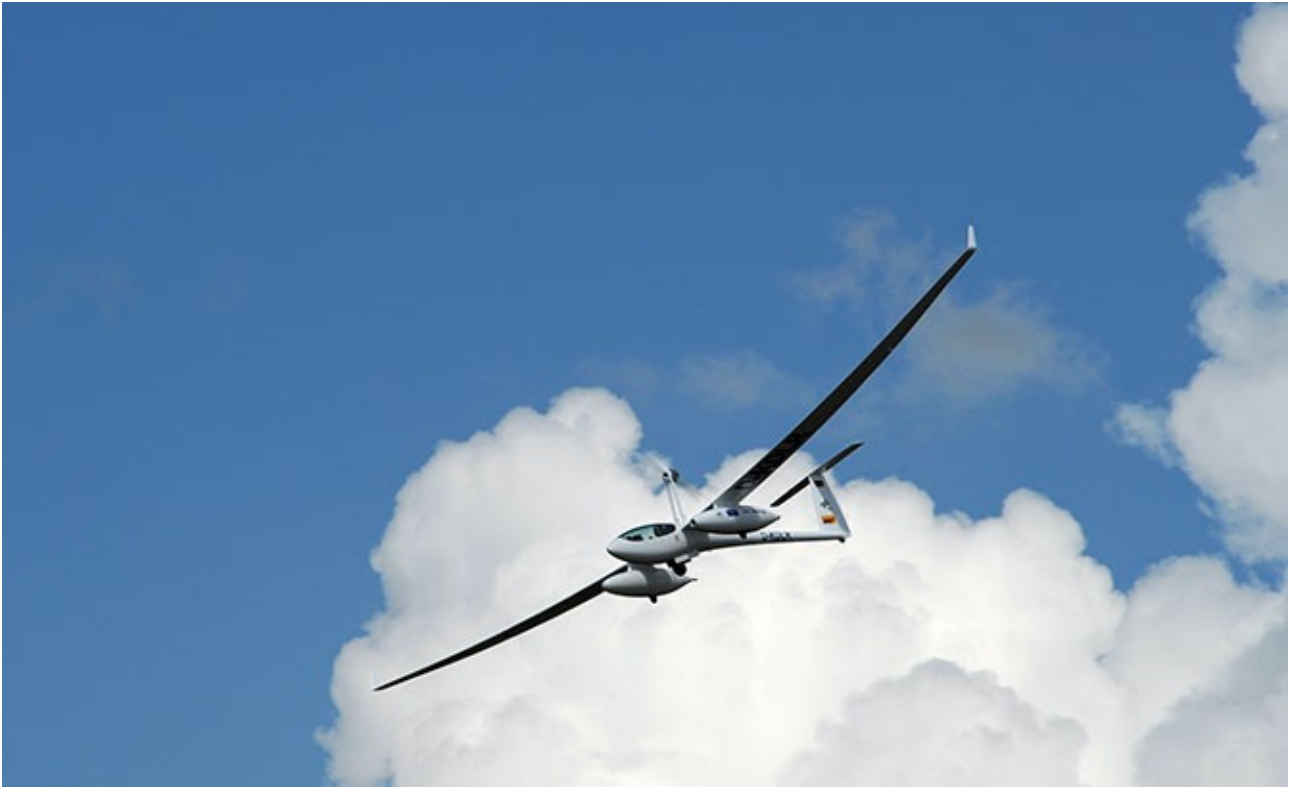
L'Antares DLR-H2 en vol. La pile à combustible est accroché sous l'aile gauche et le réservoir d'hydrogène sous l'aile de droite - avec une capacité de 2 ou 4,9 kg.
