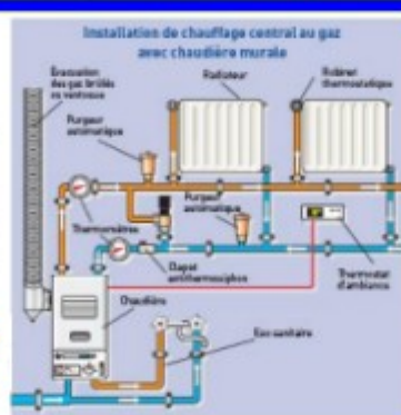
Chauffage au gaz
