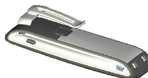
En guise d'accessoire, les modèles **Aastra 610d et 620d** peuvent également être équipés d'un clip de ceinture rotatif. De la même manière, appliquez les ergots latéraux du support de fixation au niveau des deux orifices situés tout en haut du combiné, puis emboîtez-les en pressant vers le bas. Poussez ensuite le clip sur la tête qui dépasse. Pour détacher le clip du combiné, appuyez sur la touche supérieure.
