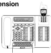
Le module d'extension permet d'équiper le poste de 20 touches programmables supplémentaires. Vous pouvez ajouter jusqu'à deux modules d'extension de clavier, pour constituer un total de 60 touches programmables.
