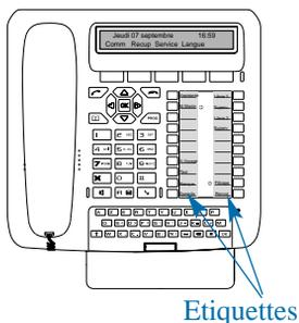
1 - **Enlevez la protection** transparente de l'étiquette en soulevant la partie inférieure (pour cela, insérez un objet pointu successivement dans les deux encoches).
