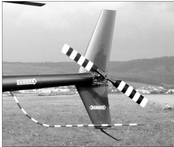
Figure 6 - Rotor anticouple d'un hélicoptère Robinson R44 .
