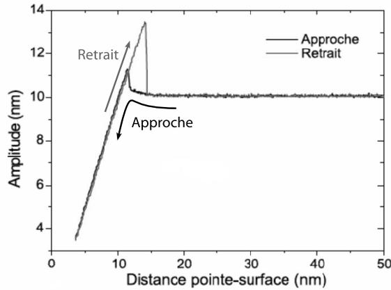
Figure 3. Courbes expérimentales d'approche-retrait pour  $\omega < \omega_0$ .
